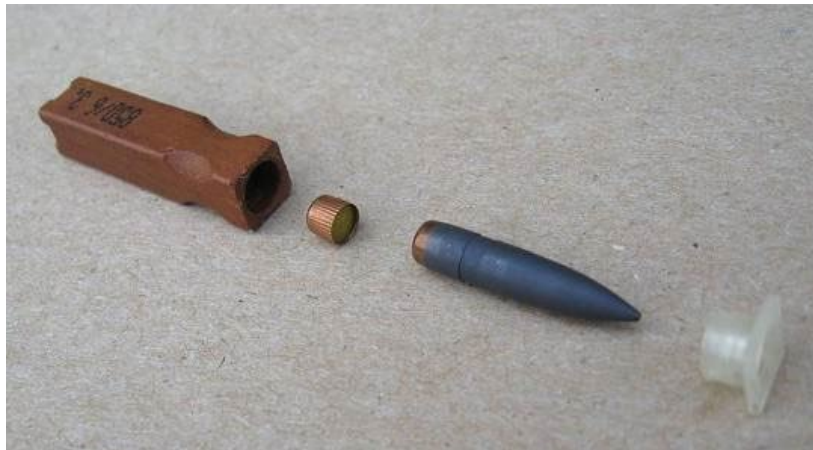
Zerlegte hülsenlose Patrone des HK G11, 4,73 × 33 mm
