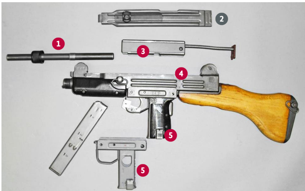
Abbildung 117 Maschinenpistole UZI, zerlegt
