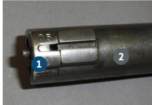
Abbildung 39: Verschlusszylinder Gewehr 88 im Detail.
