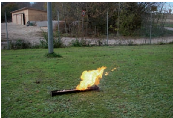
Abb. 9: 2 bis 3 sec; starker Abbrand, vereinzelt Funkenflug
