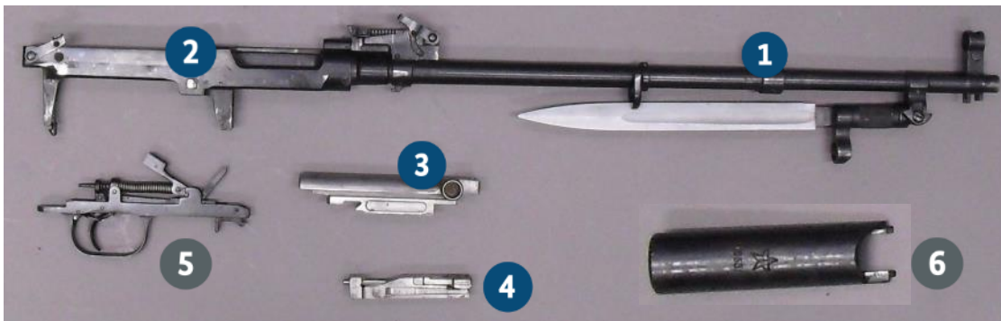
Abbildung 105: Halbautomatische Büchse Simonow SKS, zerlegt ohne Schaft.
