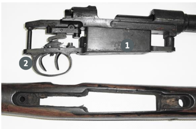
Abbildung 35 Gewehr 98 mit deutschem Stecher. Die Abzugsmechanik ist sowohl auf der Platte am Abzugsbügel als auch an der Systemhülse befestigt.
